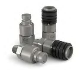
シリーズ 217 カップリングおよびニップルは、使用圧力毎の流量において、優れた性能を提供します。 フラット・フェースデザインのため、空気の混入と漏れを最小限に保ち、油圧システムと環境の汚染を防止します。また、片手で簡単に操作でき、手入れも楽に行えます。 全てのカップリングに、動作時の予期せぬ分離を防ぐ安全ロック機構が標準装備されています。シリーズ 217は、特に大流量を必要とする油圧システムに最適です。
