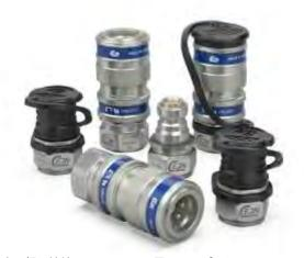
シリーズ117は、シリーズ115と同様、高性能・高品質ですが、互換性がないので、システム内で相互接続してはならない異なるアプリケーションがある場合に、横に並べて使用出来ます。レスキューツールや油圧ツールなどに最適です。本体材質は、スチール(鍍金処理)製です。また、プラスチック製ダスト・キャップは、カップリング及びニップルに標準装備されています。
