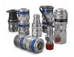
このシリーズは、ボルトテンショナー、レンチ及びベアリングプーラーなどでの使用や腐食環境での使用に適しています。極めて小さい外径寸法が特徴で、ノン・ドリップ構造が標準となっています。本体材質は、ステンレス・スチールあるいは、耐酸スチール製です。油圧システムの耐用年数を延ばすため、プラスチック製ダスト・キャップが、カップリングとニップルの両方に標準装備されています。
