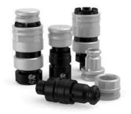
シリーズ140は、400MPaまでの高圧仕様のセインオリジナル製品です。分離時の耐圧はカップリングで400MPaまで、二ップルで300MPaです。 ノン・ドリップ構造と予期せぬ分離を防ぐ安全ロック機構を備えています。安全と品質に対するセインの取り組みの一環として、カップリング及びニップルはそれぞれ最高使用圧力で耐圧テストを実施後、提供されます。また、バルブが砂塵・金属粉等の混入により損傷するのを防ぐため、カップリング及びニップルに陽極酸化アルミニウム製ダスト・キャップが標準装備されています。主にベアリングプーラー、スプリッターボルトテンショナー、油圧テスト装置、鉱山採掘等のアプリケーションに適しています。
