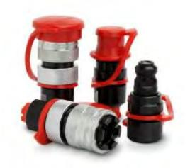
シリーズ135は、300MPaまでの高圧仕様のセインオリジナル製品です。このシリーズは、分離時(カップリングとニップル)の耐圧も300MPaまでです。ノン・ドリップ構造は、セインの高圧レンジの標準となっています。カップリングは、予期せぬ分離を防ぐ、安全ロック機構も付いています。プラスチック製ダスト・キャップは、カップリング及びニップルに標準装備されています。ニップルは、スイベルタイプとノン・スイベルタイプがございます。カップリング及びニップルはそれぞれ最高使用圧力で耐圧テストを実施後、提供されます。このシリーズは、非常に高い圧力において、迅速、安全及びより便利なポンプとアクセサリーの接続を可能にします。主にベアリングプーラー、スプリッター及び油圧テスト装置に適しています。
