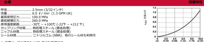
※ 流量は、圧力損失0.4 MPa時の計測値です。
