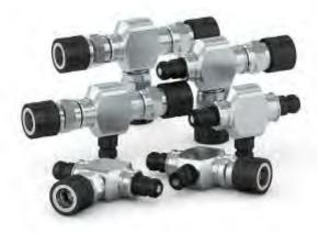
セインの116T型接続シリーズは、軽量目つカップリングとニップルを組み合わせた一体型で、ボルトテンショナーやシリンダーなどの高圧油圧 ツールで分岐を要するアプリケーションに最適です。品番が少なくとも5種類ある最大13個の部品が必要だった従来の分岐ブロックをコンパクトな T型接続に置き換えることができるので、潜在的な漏れ箇所を減らし、漏れのリスクを最小限にします。特殊なシールが採用されているため、分離 時に加圧されてもシール損傷のリスクがありません。また、漏れ検査を含むコンポーネントを完成品として提供しますので、作業時間と費用を節約できます。
