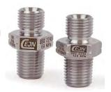
60°メスコーン付きNPT x G (BSPP)工業規格アダプター。コンパクトデザインで、高耐久のNACE認定ステンレス・スチール AISI 316L / EN1.4404 製です。完全仕様の組立図及び推奨トルクがダウンロード可能です。
