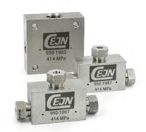
工業規格のクロス、T型、エルボーブロックはコンパクトデザインで高耐久性のAISI 316L / EN1.4404 ステンレス・スチール製です。またネジ部には安全のため、穴(weep hole)が加工されています。全てのブロックはカラー及びグランドナット付きです。
