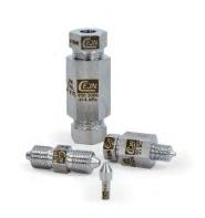
セインのステンレス・スチール製アダプターは、工業規格414MPaの対応チューブに基づいて設計されており、異なるネジタイプ、シールタイプに適合します。完全な仕様組立図及び推奨トルクは、ダウンロード可能です。様々な構成が可能な工業規格アダプターです。コンパクトデザインで高耐久性のAISI 316L / EN1.4404ステンレス・スチール製です。
