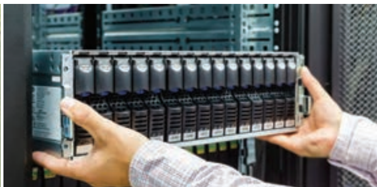
Elektronikeinschübe mit versteckt steckbaren Kupplungen
